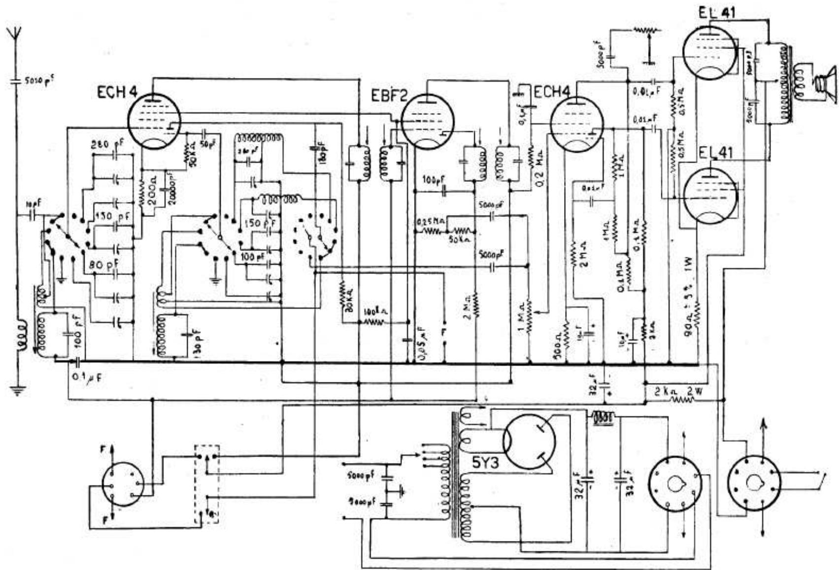
ABC RADI COSTRUZIONI - Mod. 972 (il mod. R 972/FM è uguale, con in più il sintonizzatore FM a cinque valvole) - Sintonia a permeabilità variabile e doppia espansione di gamma. La seconda ECH4 provvede alla preamplificazione BF e all'inversione di fase. Potenza d'uscita a 4,5 watt indistorti.
